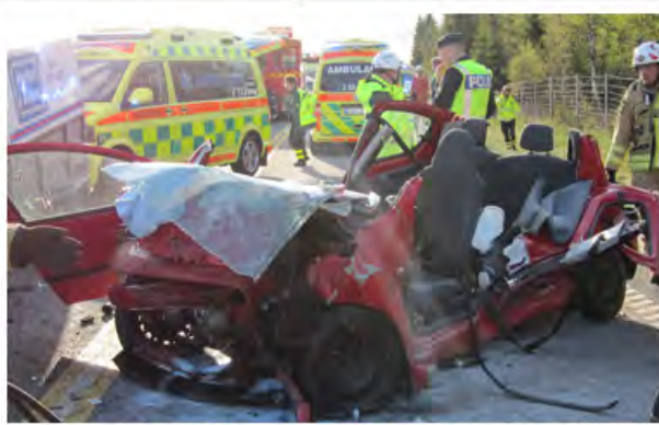
Peugeoten är rejält frontalkrockad och även intryckt på förarsidan. Fotot är taget på olycksplatsen efter det att räddningstjänsten klippt tak plus A-B-C stolpe på förarsidan. Räddningstjänstens foto.
