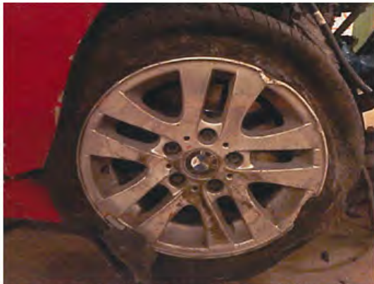
Foto ovan och till höger som visar att BMW:ens högra framdäck inte rullat lufttomt. Polisens foto.
