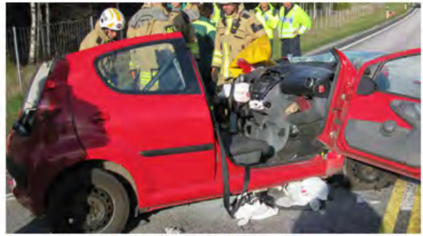
Fotot visar att förarsidans Airbag har utlöst men på passagersidan har Airbagen inte utlöst. Bilbältet på passagersidan har vid uttagning av passageraren fastnat i utdraget läge. Förstorar man upp fotot går det att se att luckan till Airbagen har böjats öppna sig. Räddningstjänstens foto.
