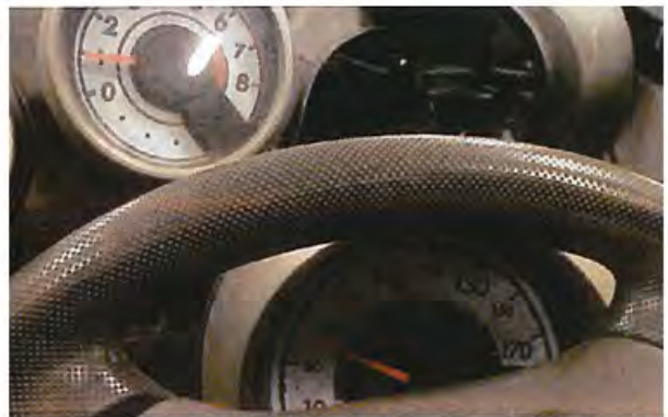
Fotot visar att hastighetsmätaren har fastnat på 45 km/h och varvräknaren på 1000 varv/min vid kollisionsogonblicket. Polisens foto.
