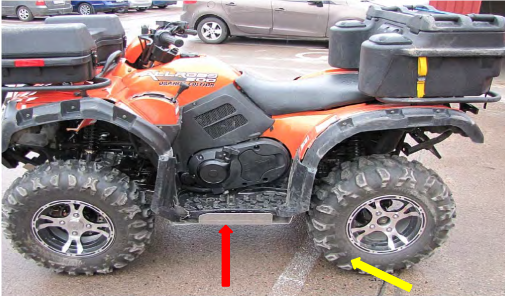
Bild 3. Röd pil visar hasplåten , gul pil visar däckets framkomst. vid
