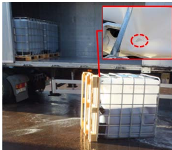
Bild 3. IBC-behållare när den var välvt. Bilden visar även hur mycket vätska som runnit ut från behållaren. Foto: RSG
