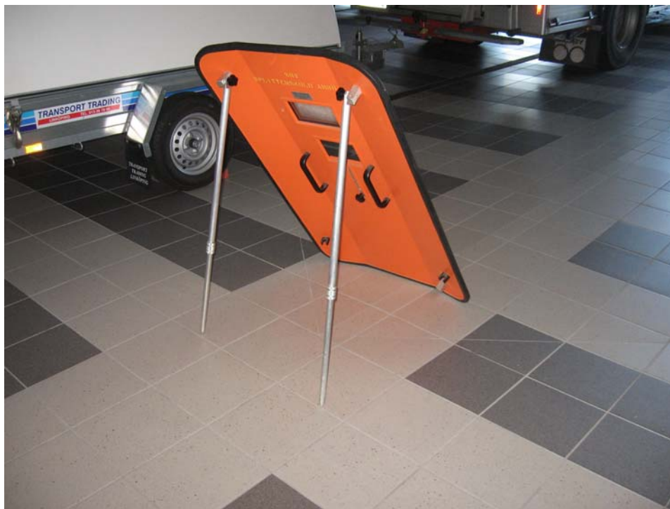
Bild 3. OXA splitterskydd som användes som skydd vid skjutning av gasflaskan.
