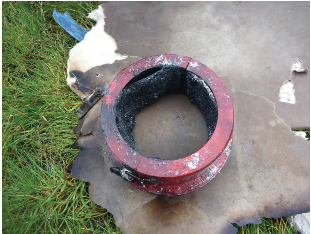
Bild 9 Rörstryparen* i schakttoppen uppvisar endast ringa brandpåverkan och har endast aktiverats lite grann vilket stödjer teorin att branden inte spridit sig via schaktet.
