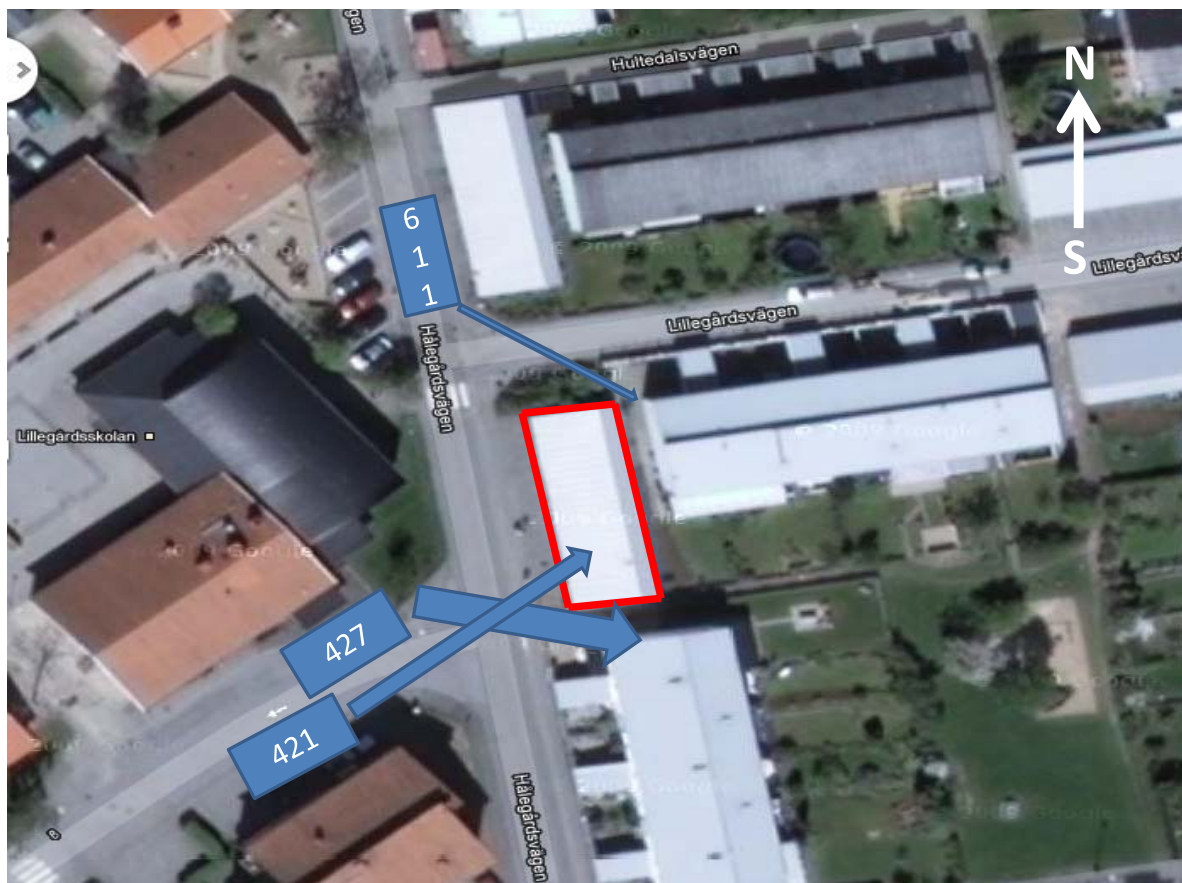
Bild 3. Bild över var de första åtgärderna sattes in. De olika tjocklekarna på pilarna visar skillnader i vattenmängd som användes på respektive plats.
