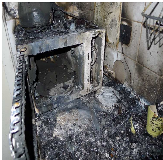
Bild 2. Mikrougn med bränd EL- del, höger
