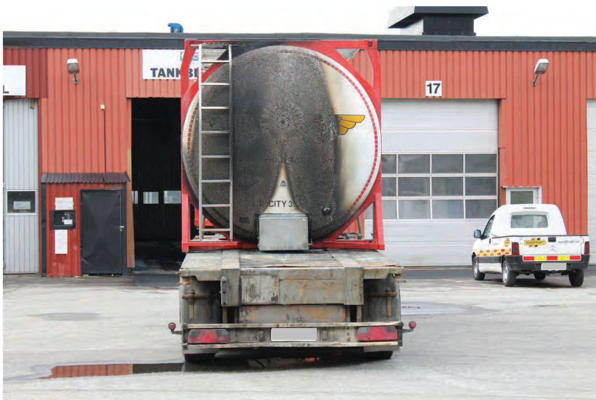
Figur 2 Här syns den brandbelastade tankgaveln.
