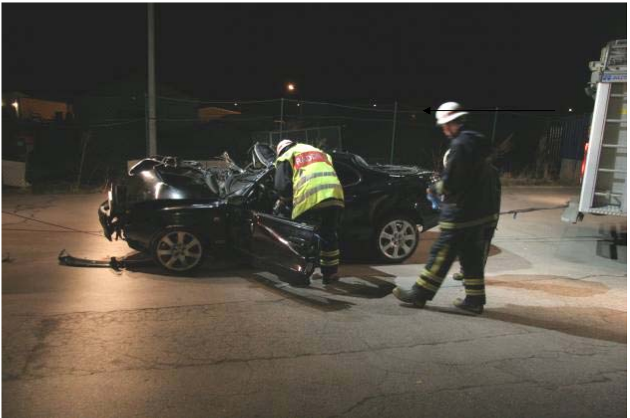
Bilen isärdragen ca: 0,7 m och spänning i vajer släppt.
