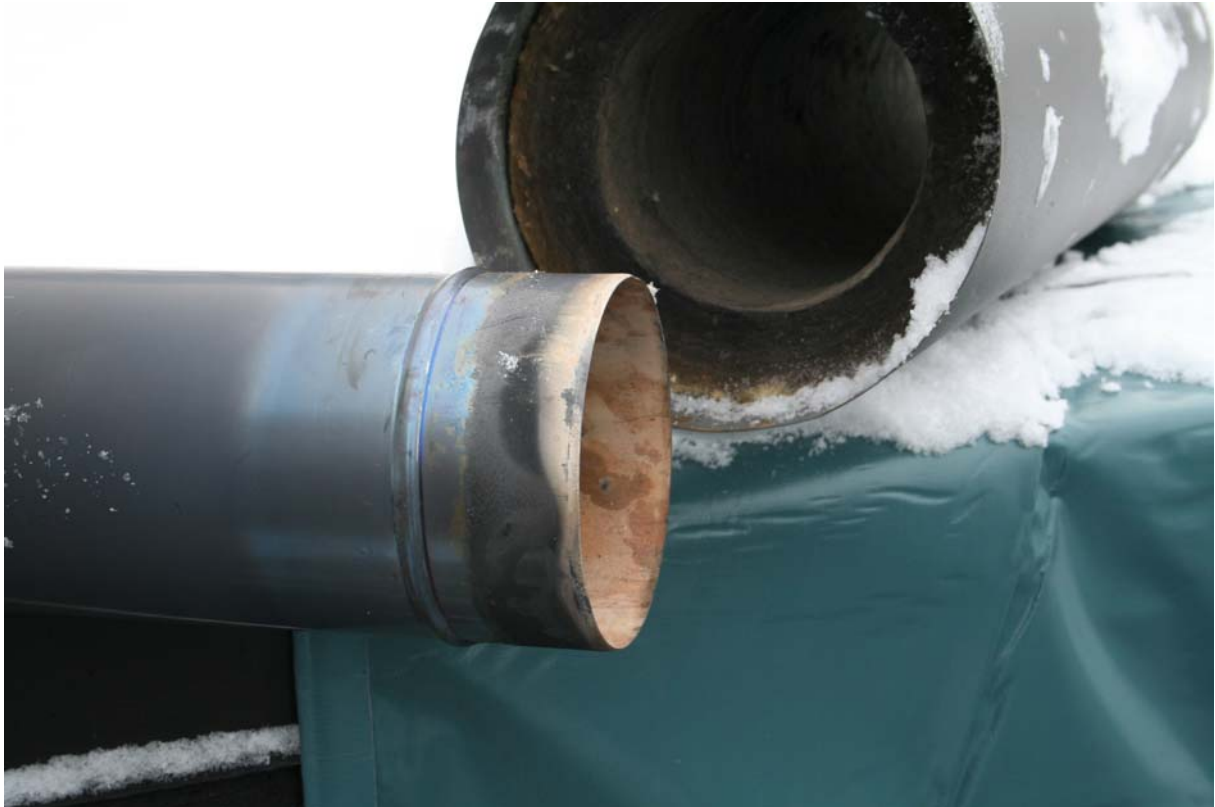
Bild 4. Blåneringen på röret talar för höga rökgastemperaturer.
