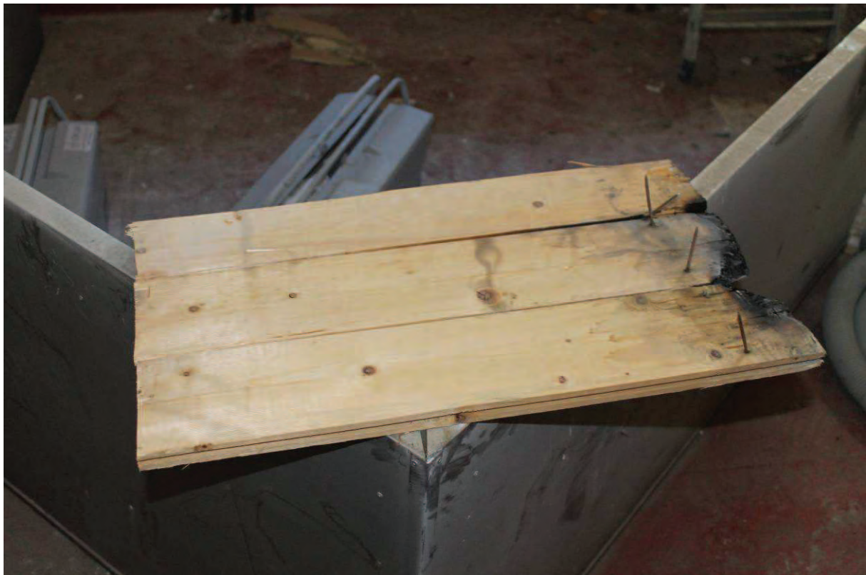
Figur 5 Jag hittade tre bräder som hade suttit mot ventilationen vid figur 4. Ytan som var mot det gipsade innertaket är helt obränd.....
