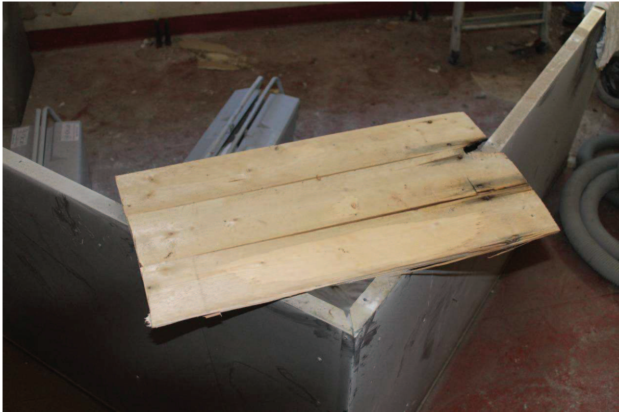
Figur 5 Jag hittade tre bräder som hade suttit mot ventilationen vid figur 4. Ytan som var mot det gipsade innertaket är helt obränd.....
