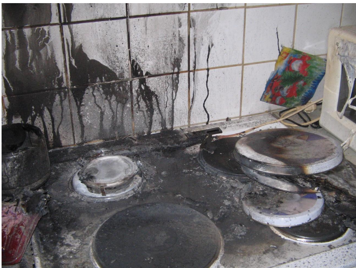
Bild 2. Spisen med rester av någon form av värmeplatta.
