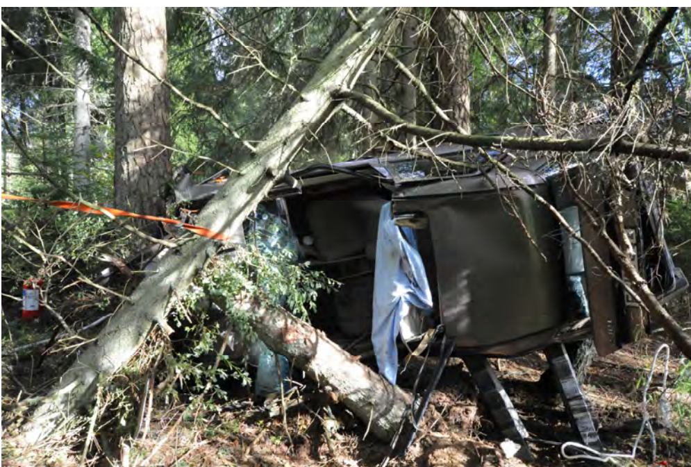
För att stabilisera bilen användes bl.a. spännband och kilar.
