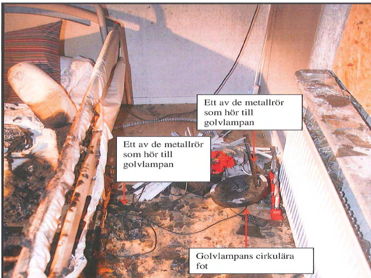
Bild 4. Avstånd mellan sängens långsida och rummets fönstervägg är ca. 80 cm. På bilden finns även markerat golvlampans delar. Till vänster syns även sönderbränt skydd till sänggrind.
