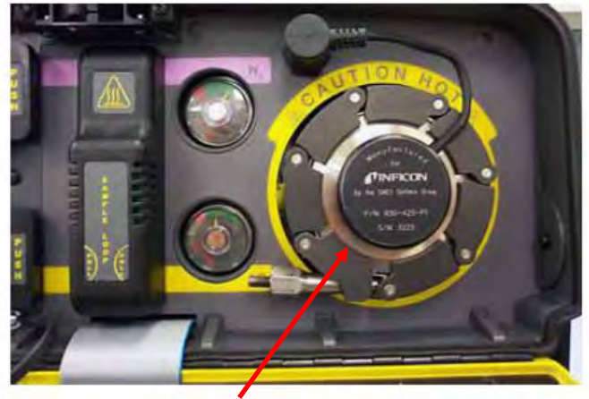
Kammare i Hapsite som håller 400° C.
