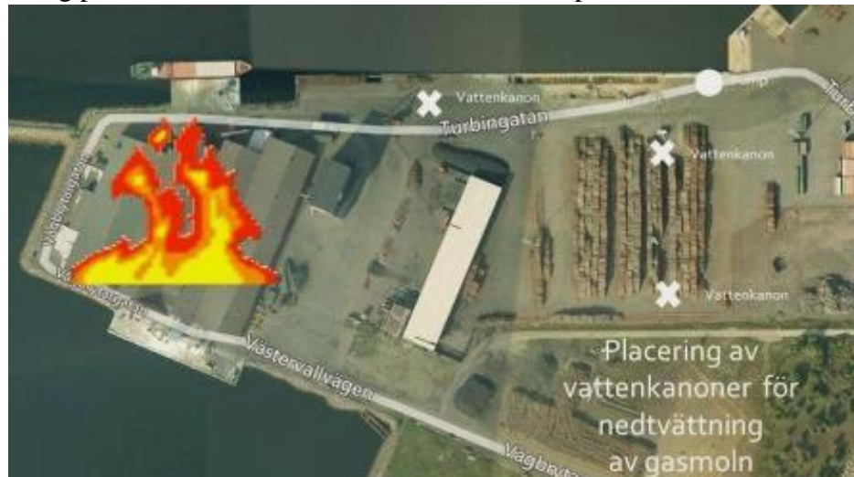
Bild 18: Vattenkanonernas placering (vattenkanon = x) - 15:30 - 120922
