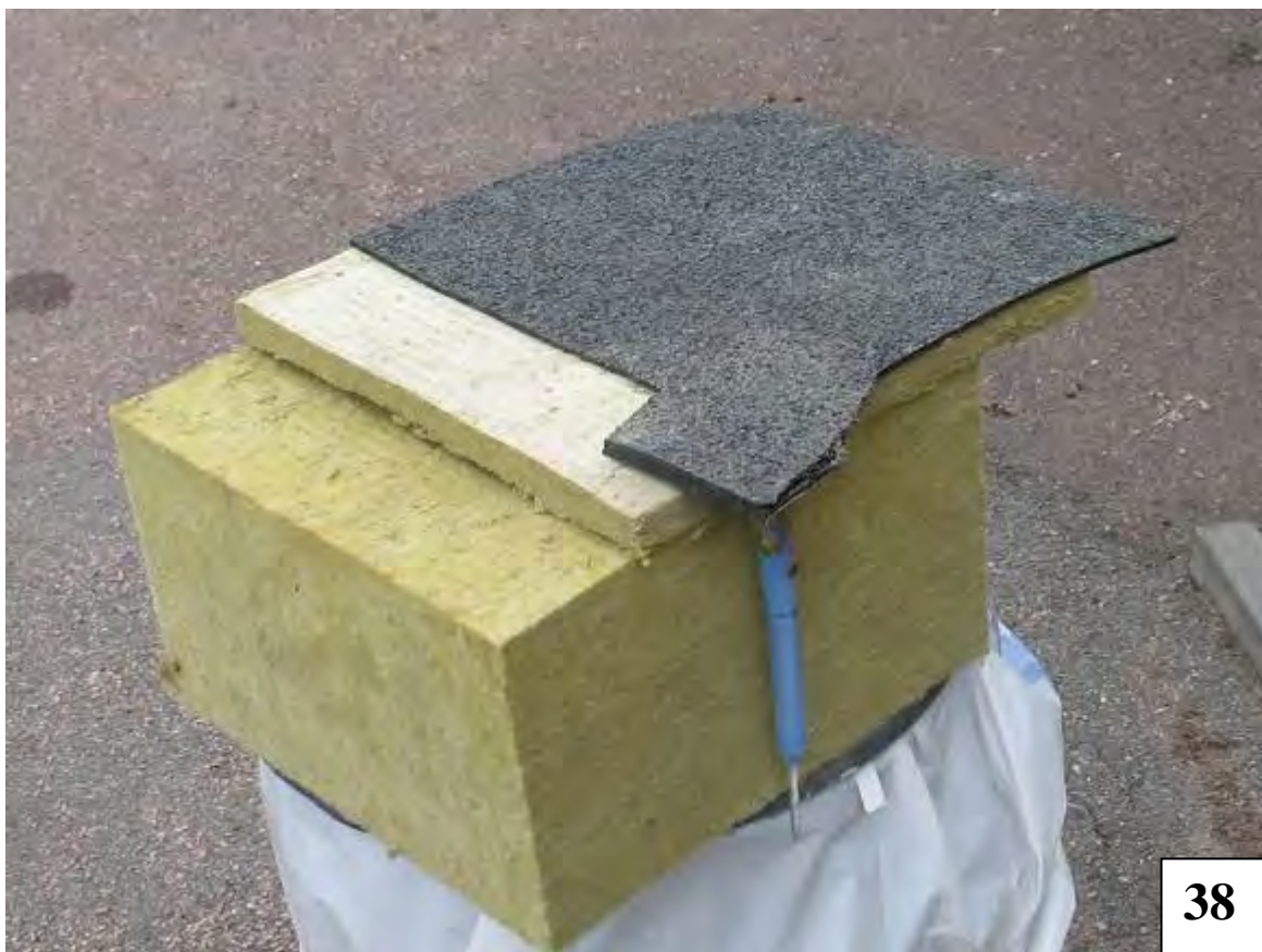
Isolering med takpapp samt förankring av takpappen.
