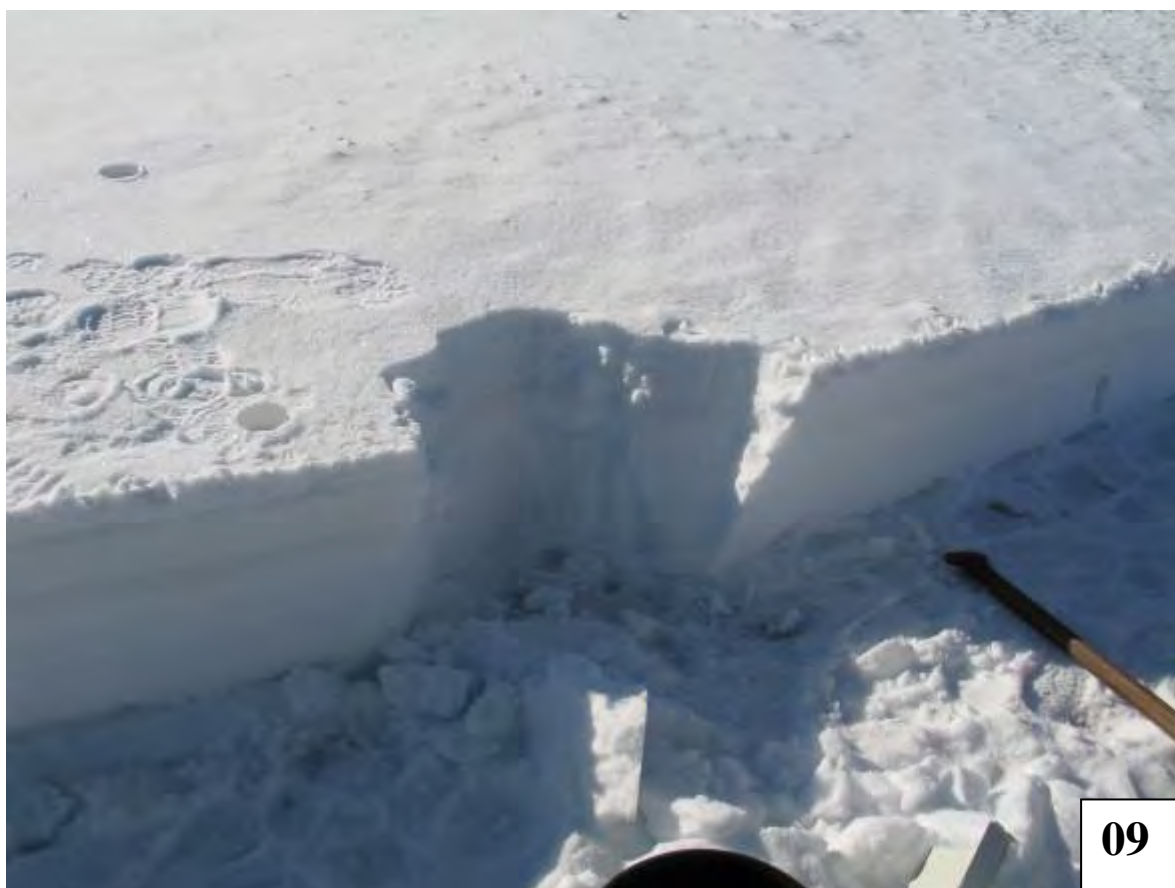
Densitetsprov två har tagits och skall mätas, snöns kant uppmättes till 46,5 centimeter. Vikten blev 135 \text{ kg/m}^2 .
