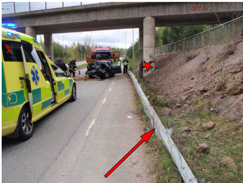
Bild 5: Röda pilen visar räcknet som fordonet kör upp på och röda stjärnan visar islaget i bropelaren.
