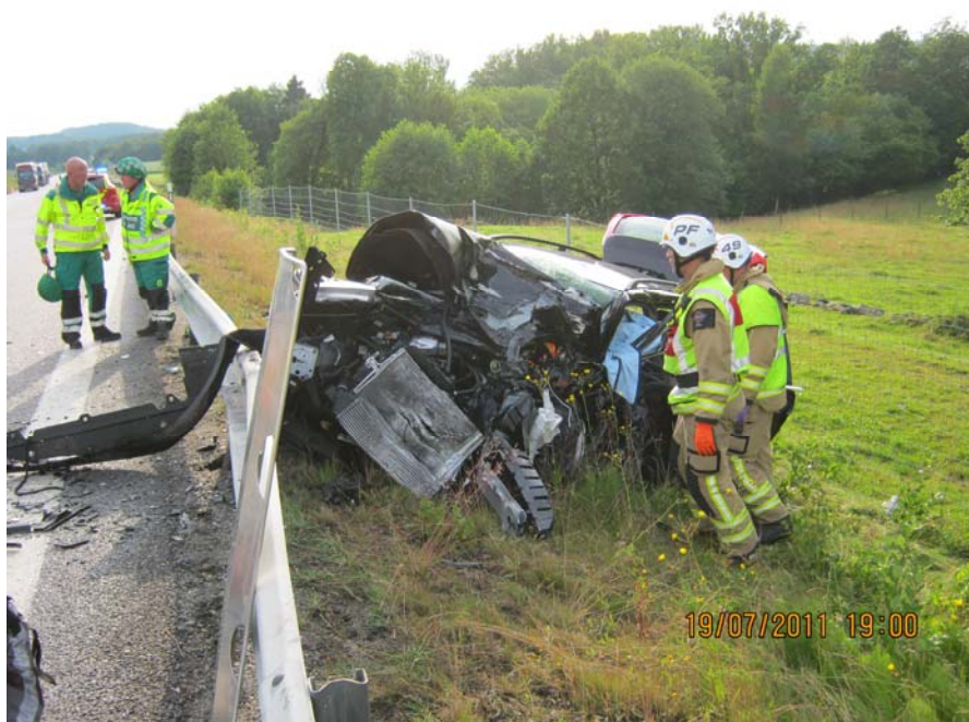
Krockskador Volvo V70
