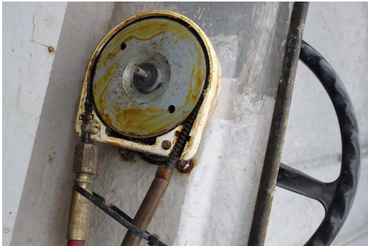
Bild 6. Bilden visar efter att skyddslocket avlägsnats. Det fanns inte heller där några fel inne i styrsnäckan.
