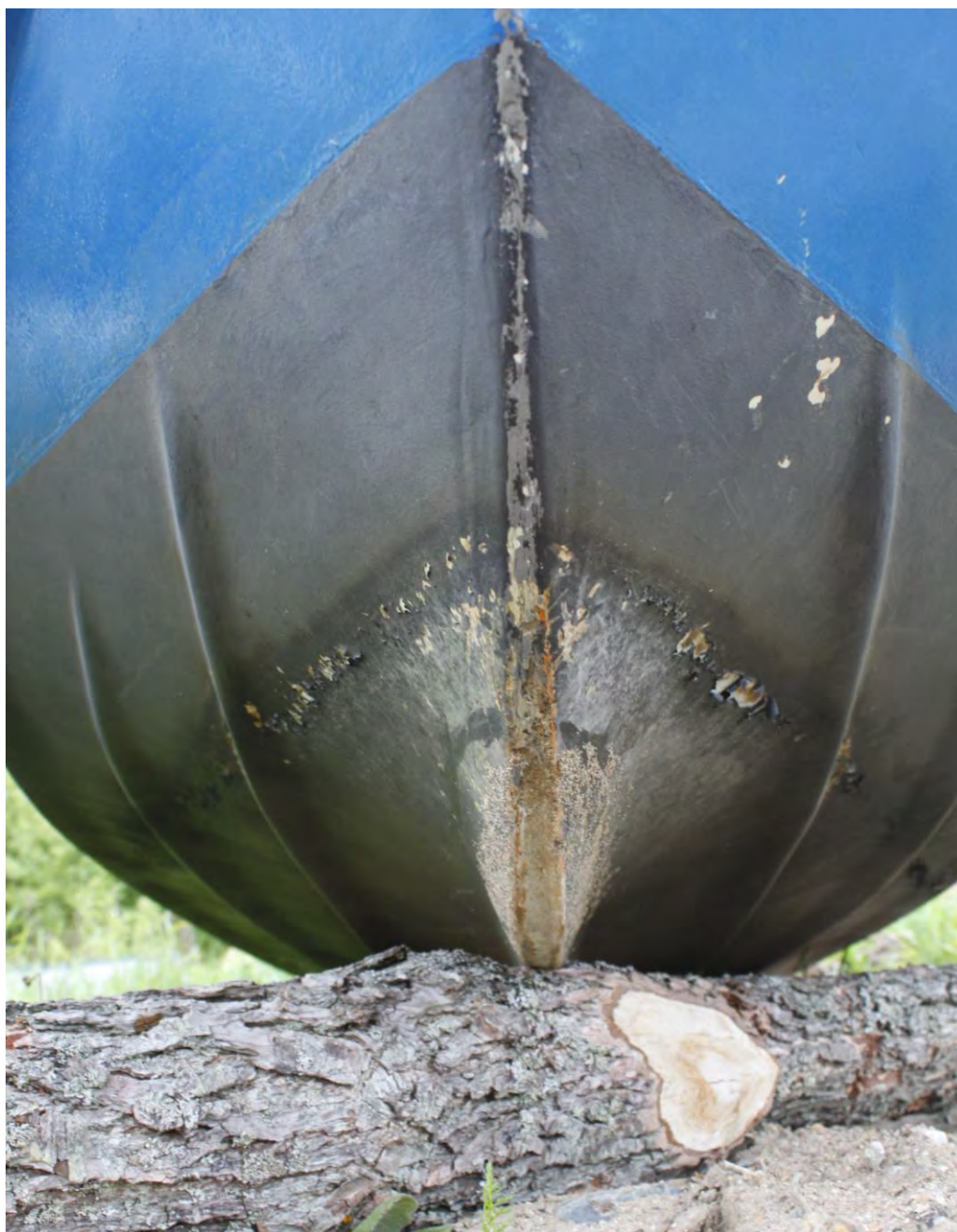
Bild 3. Bilden visar båtens underrede som inte hade några skador förutom normalt slitage.
