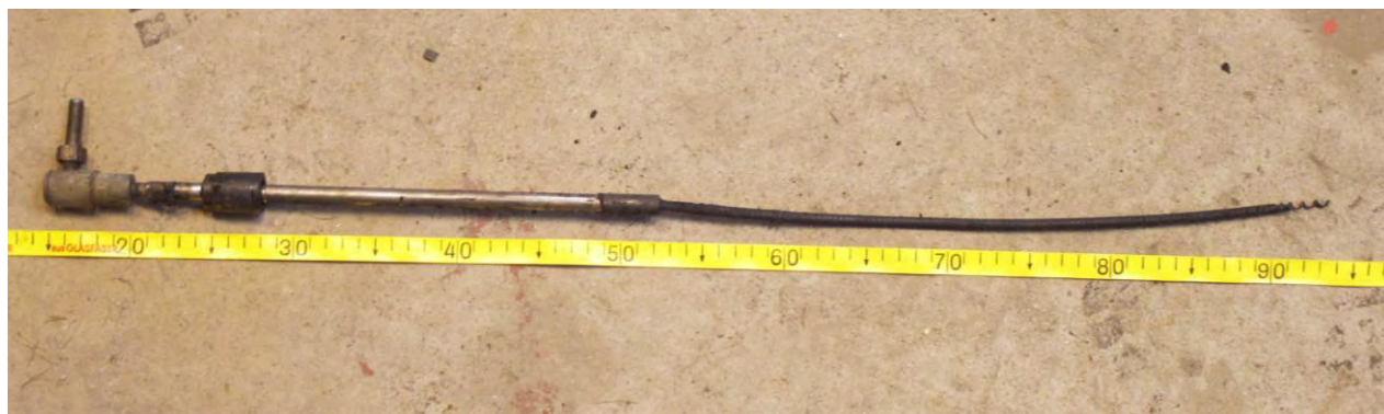
Bild 7. Bilden visar styrvajern där den sitter fast i motorn och där vajern fått ett brott och gått av.
