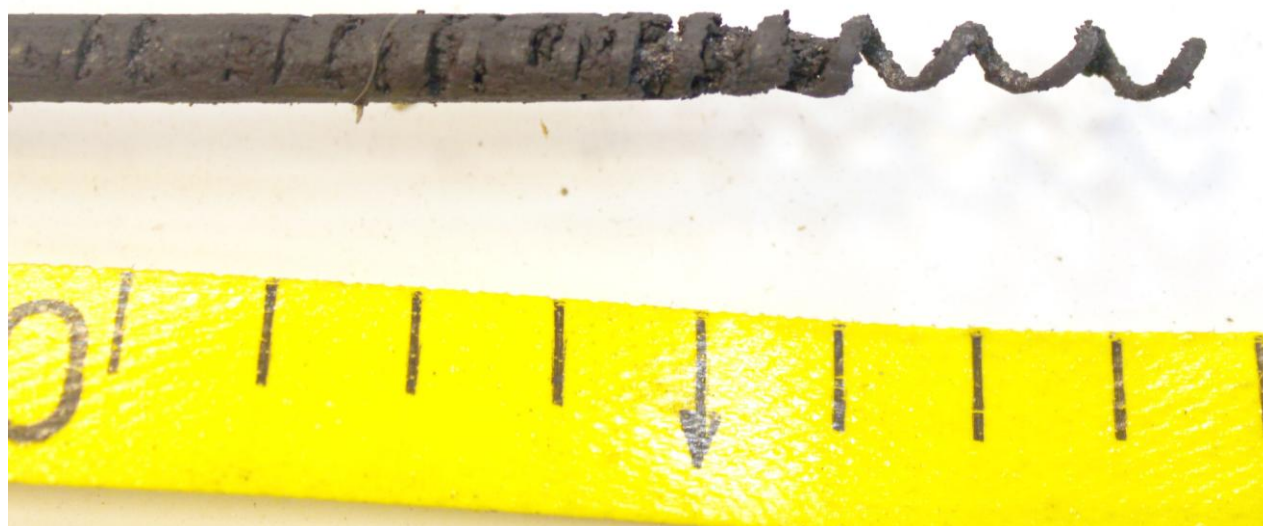
Bild 8. Bilden visar styrvajerns brott i närbild.
