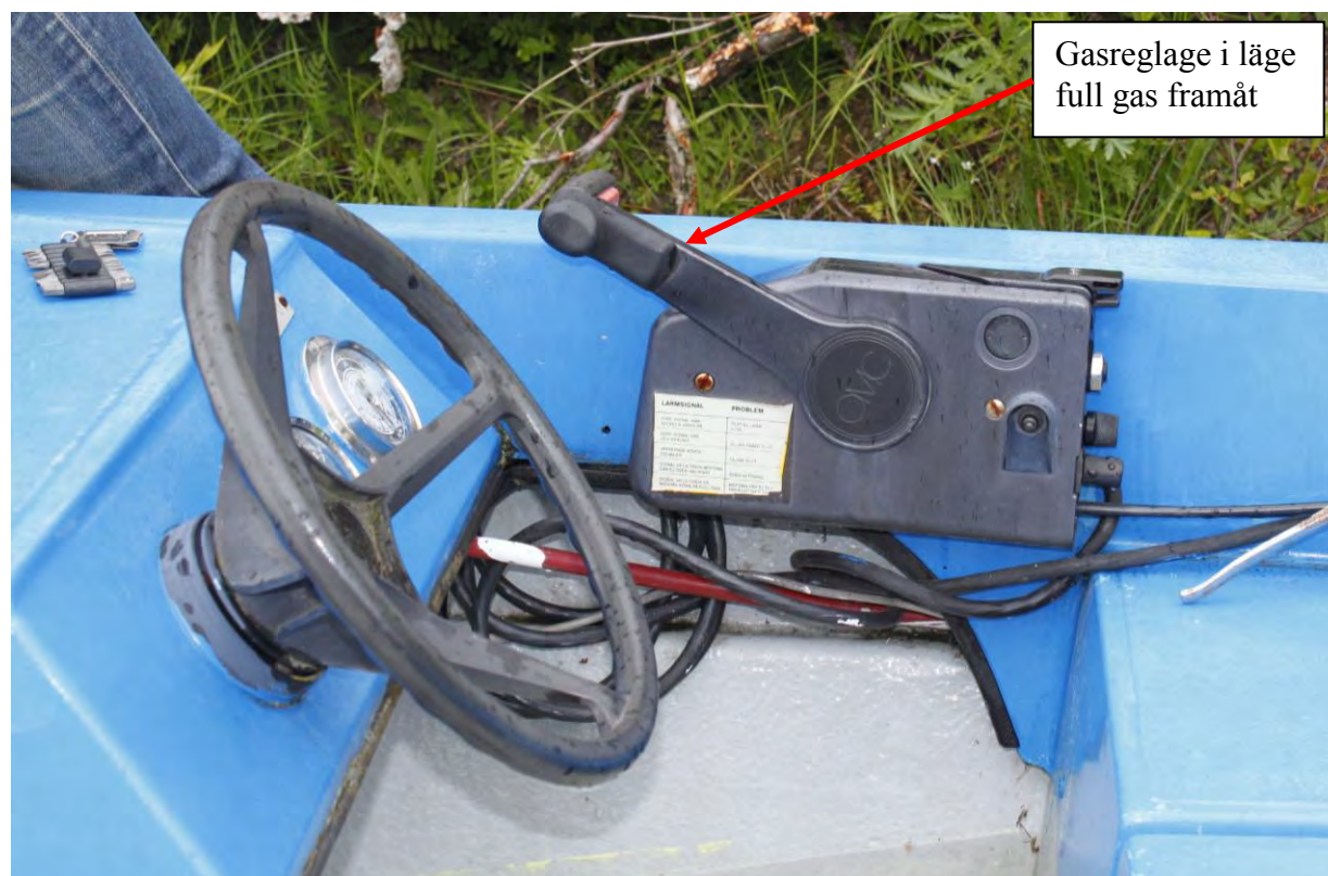
Bild 2. Bilden visar förarplatsen och att gasreglaget är framskjuten i läge "full gas framåt". Nyckeln saknades vid undersökningen.
