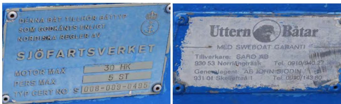
Bild 9 och 10. Bilderna visar de fastnitade typskyltar som fanns på båten, sjöfartsverkets typskylt och tillverkans företagsskylt.
