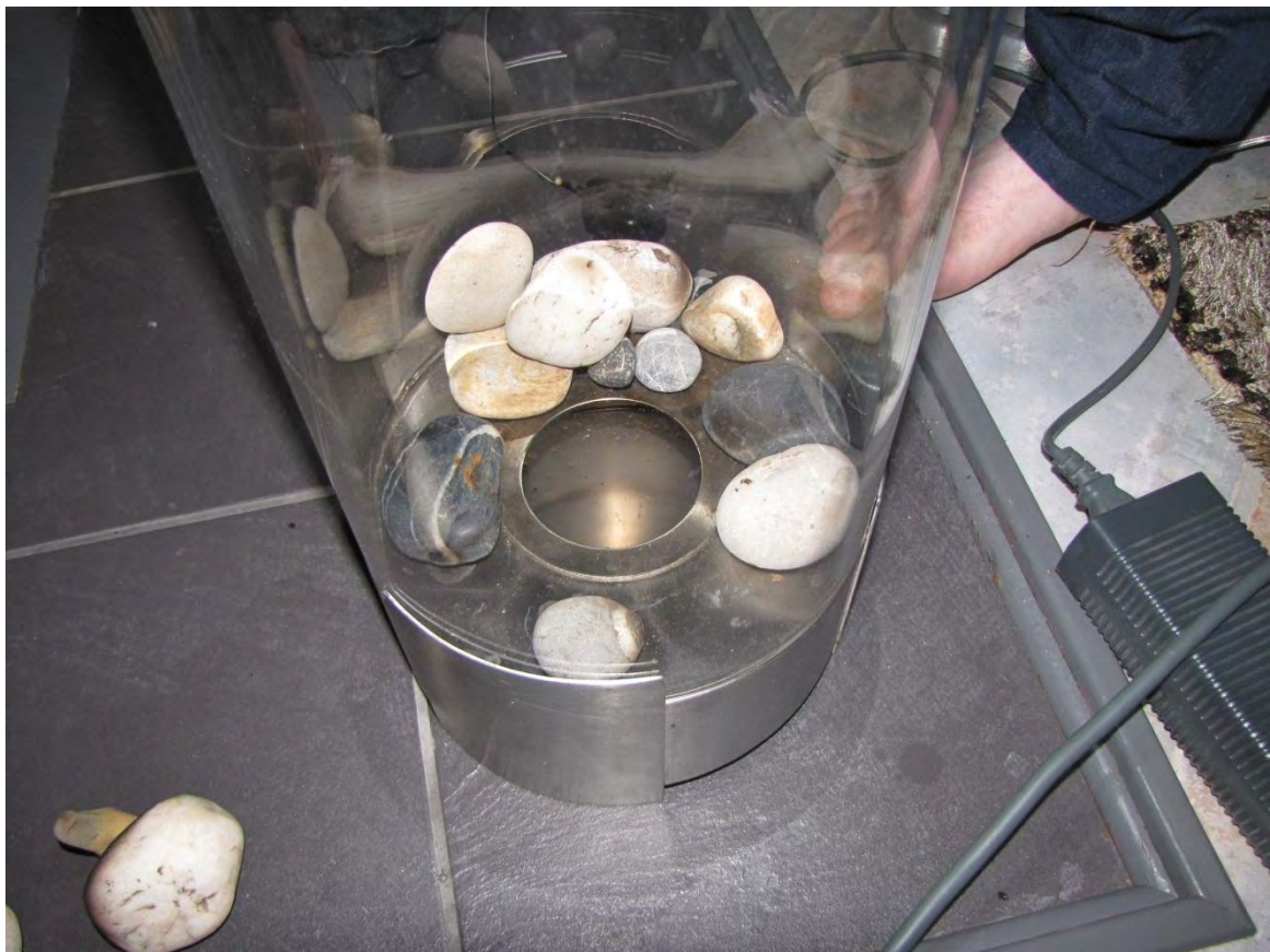
Bild 6. Bränslebehållaren plats i lampan samt uppsamlingen under där vätskan samlades vid överfyllnad det fanns även vätska bland stenarna.
