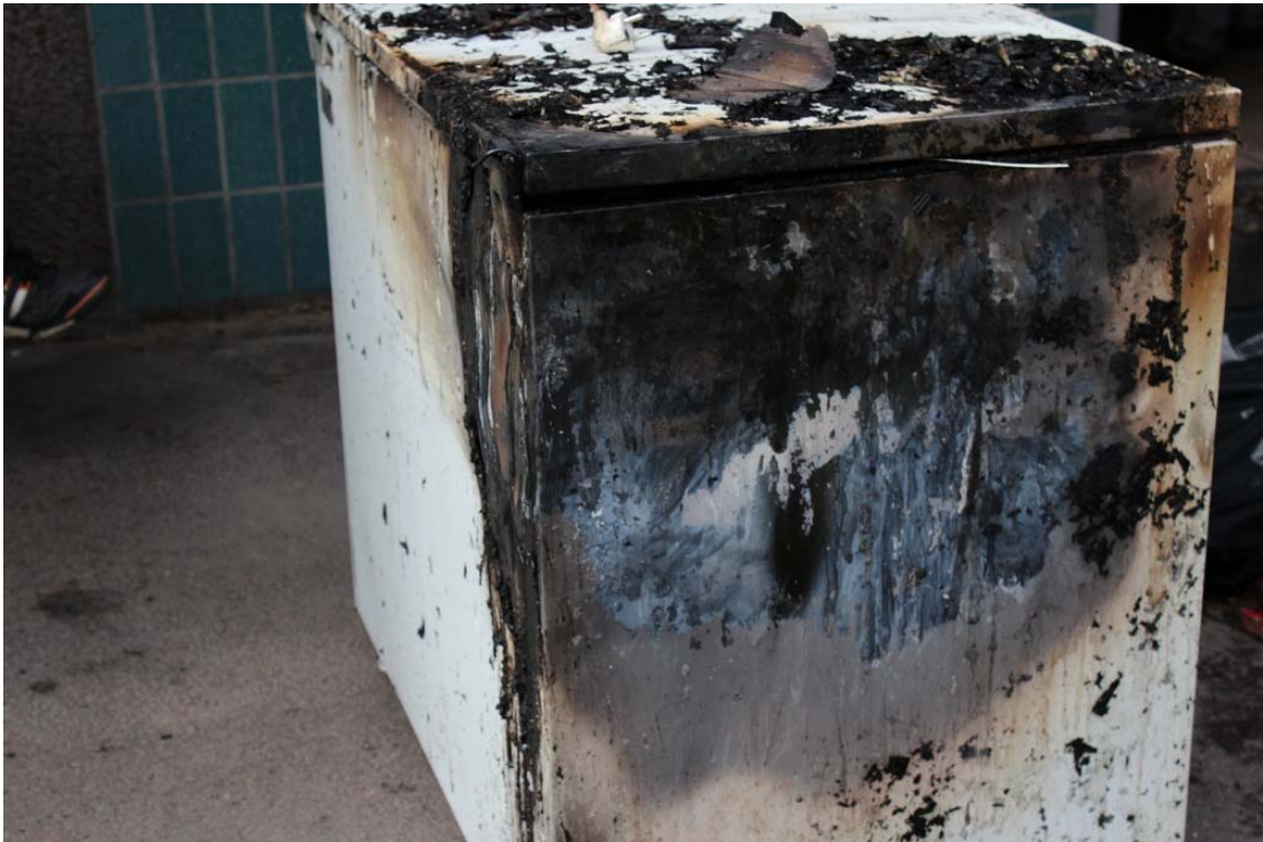
Bild 3. Frysboxen är värmepåverkad utifrån.
