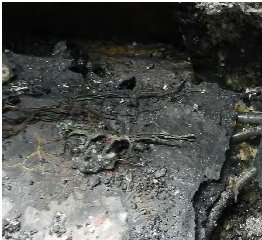
Bild 9. Delar av grenkontakten som sannolikt är brandstiftaren
