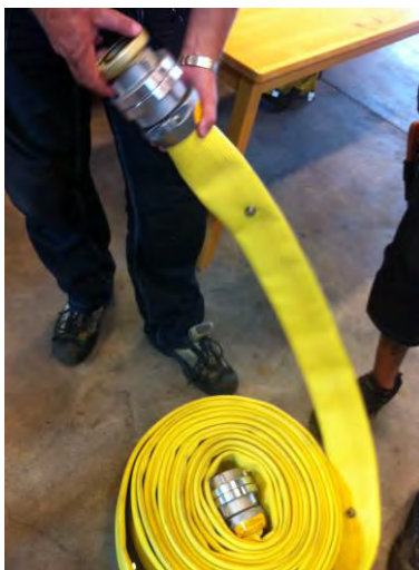
Bild 8. Övergångskopplingen på Donsös sprinklerslang saknades.
