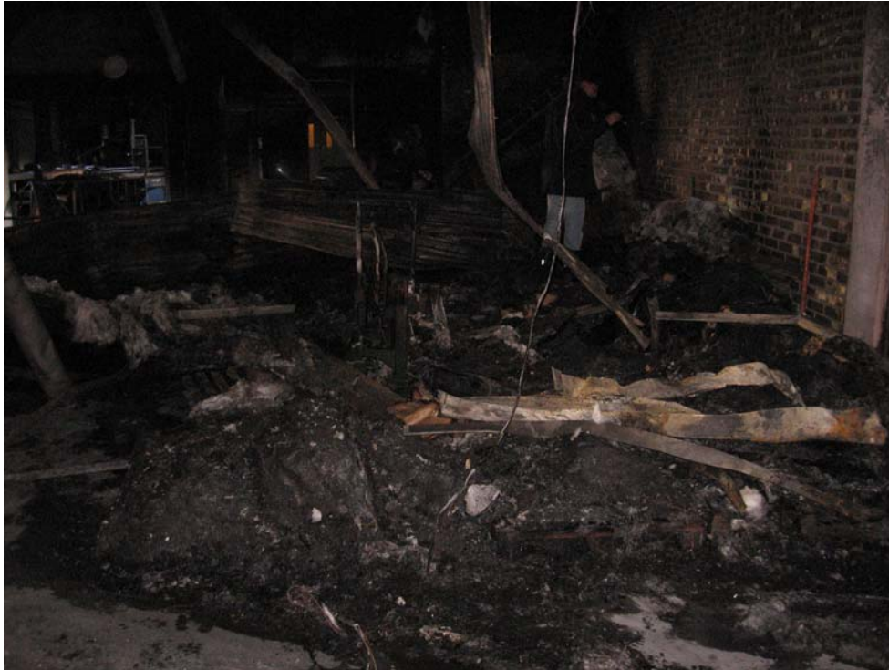
Bild 3. Rester av pallar med syntettyg som smält och brunnit som pölbränder.
