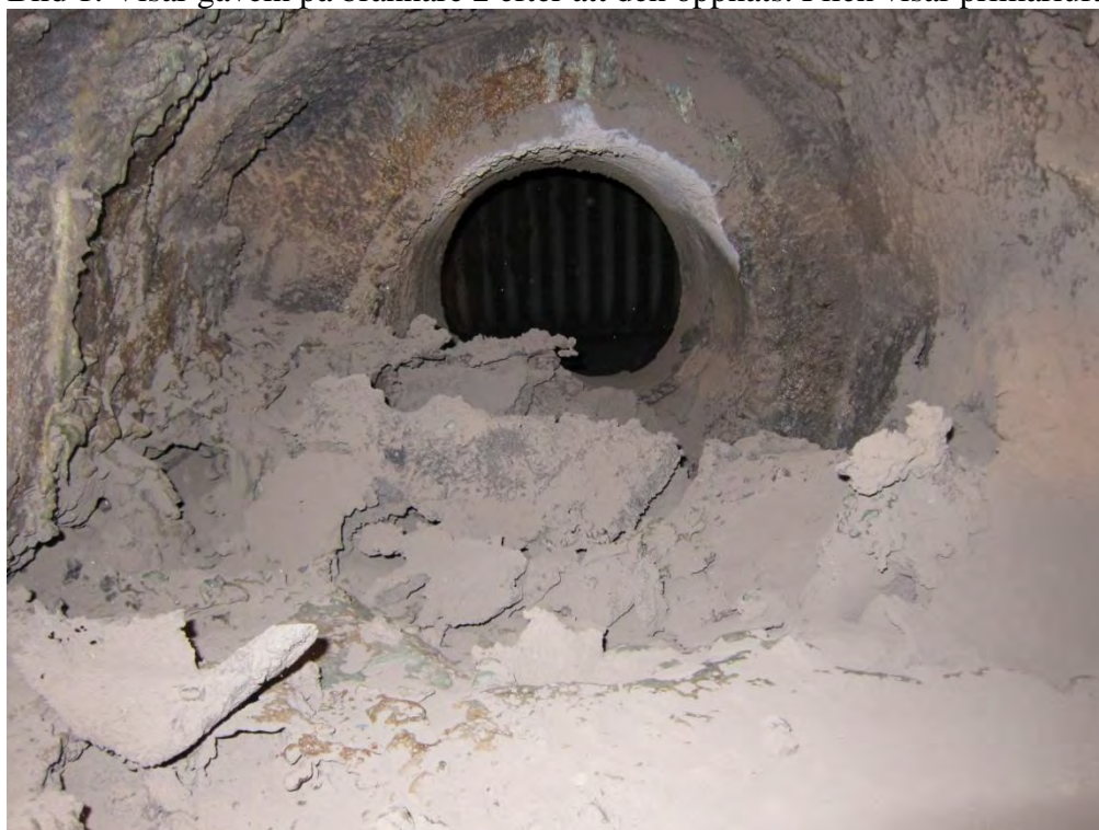
Bild 2: Visar hur brännare 2 ser ut invändigt, innan den rensats ur på de slaggprodukter som samlats i botten på brännaren.
