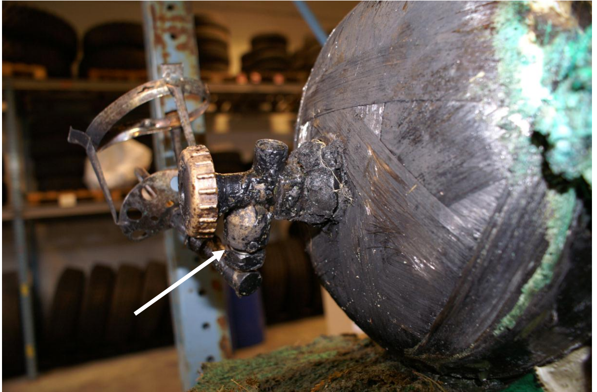
Resterna av flaska och lykta. Läckaget har varit vid pilen.
