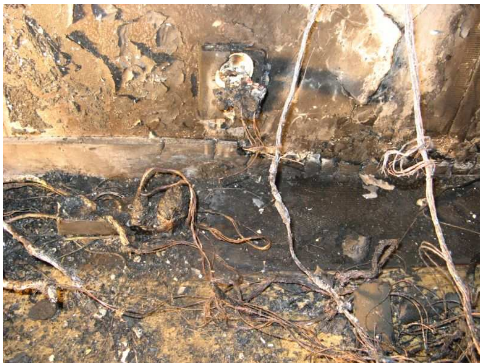
Bild 9. Trolig brandstiftare är grenuttaget
