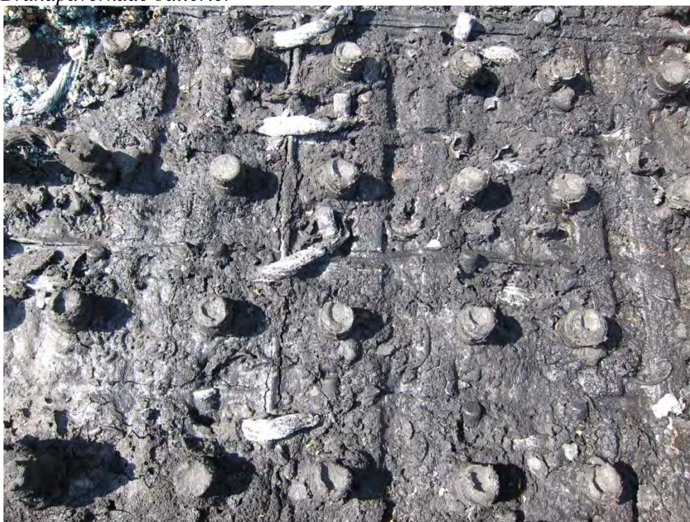
Den höga värmen smälte plasten och vätgas läckte ut
