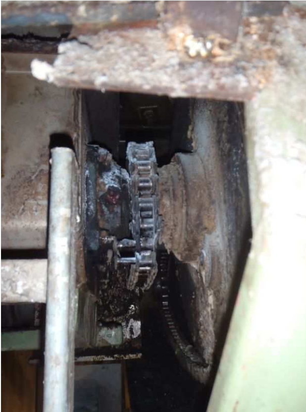
Bild 14 och 15. Drivningen av skruven där kedjelåset har lossnat och slagit bultarna krokig på lagerbocken.
