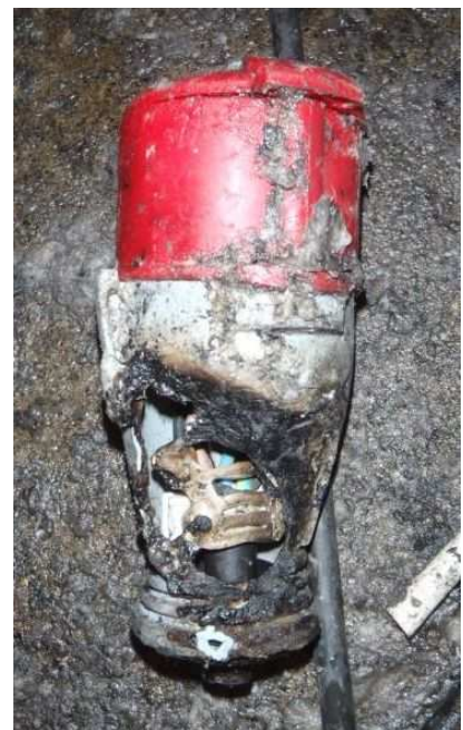
Bild 16 och 17. Elkabel och 16 amp. Skarvuttag som smält och brunnit pga. brinnande nedfallande cellulosarester.
