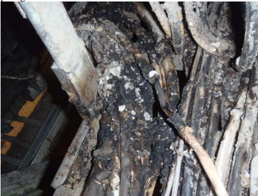
Bild 16 och 17. Elkabel och 16 amp. Skarvuttag som smält och brunnit pga. brinnande nedfallande cellulosarester.
