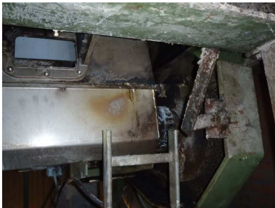
Bild 10. Utsidan av skruven där branden varit på insidan, samt drivningen.
