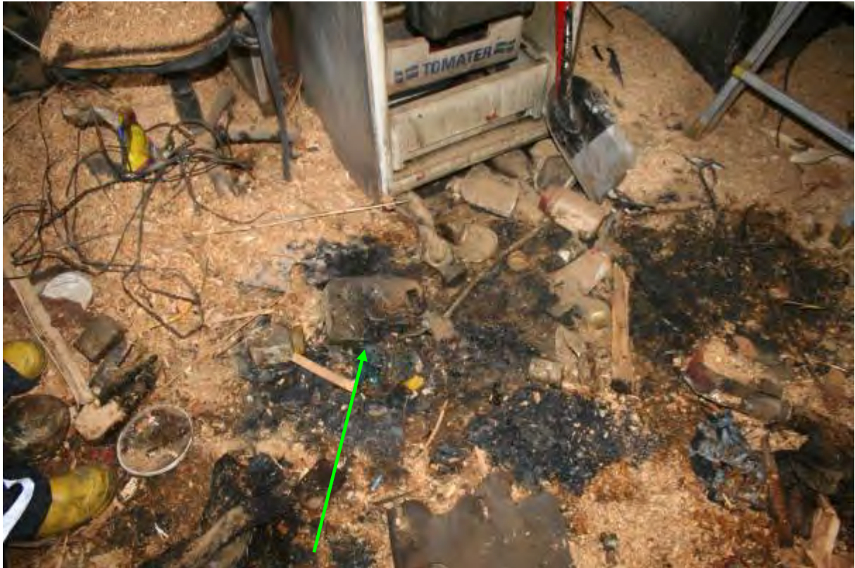
Bild 9. Plastdukar med brännbar vätska fanns på golvet.
