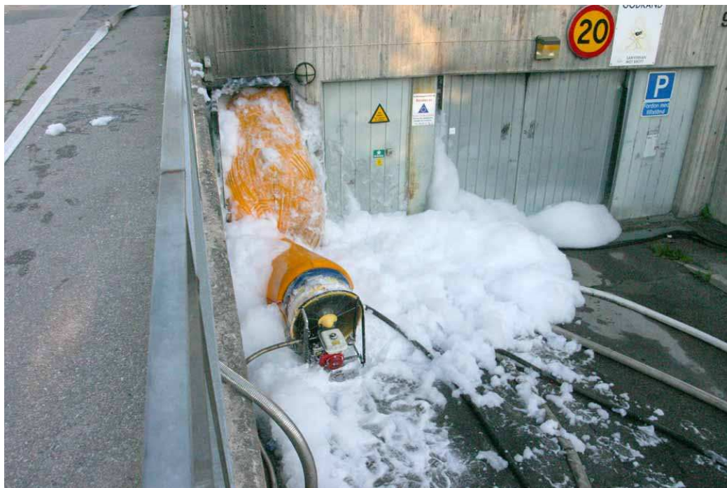
Sektor 1: ”Skumsläckning” via brandcell 1. Foto: Claes Arnheim
