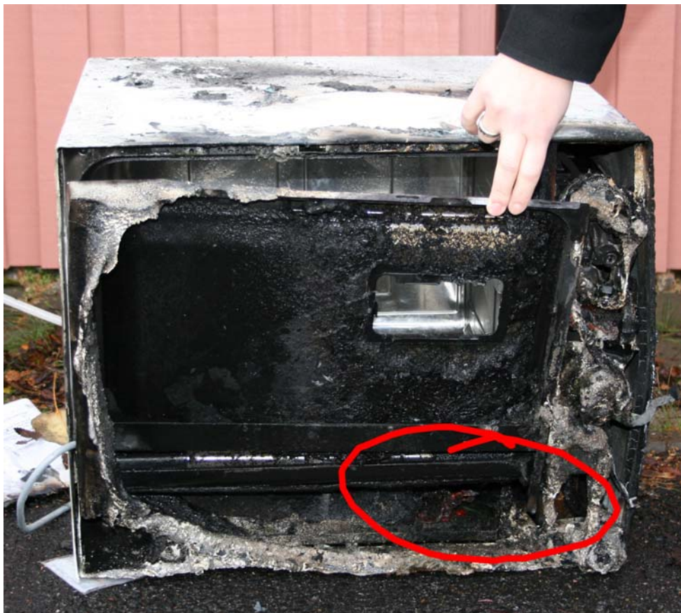
Bild 4. Den inringade ytan visar att det är intill diskmaskinens tömningspump(röd) som det brunnit genom den isolering som avskiljer maskindelarna som är monterade under diskmaskinen.
