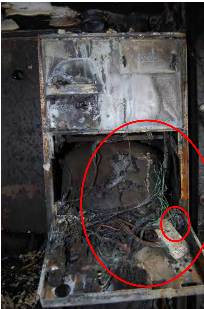
Bild 7. Brandskador där "elektroniken" finns och den troliga primärbrandplatsen markeras med den stora röda ringen. Den mindre ringen visar värmevaktens placering.
