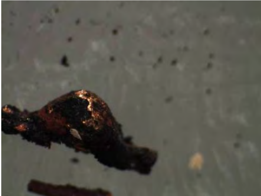
Bild 12. Kortslutningsskada på en av ledarna.
