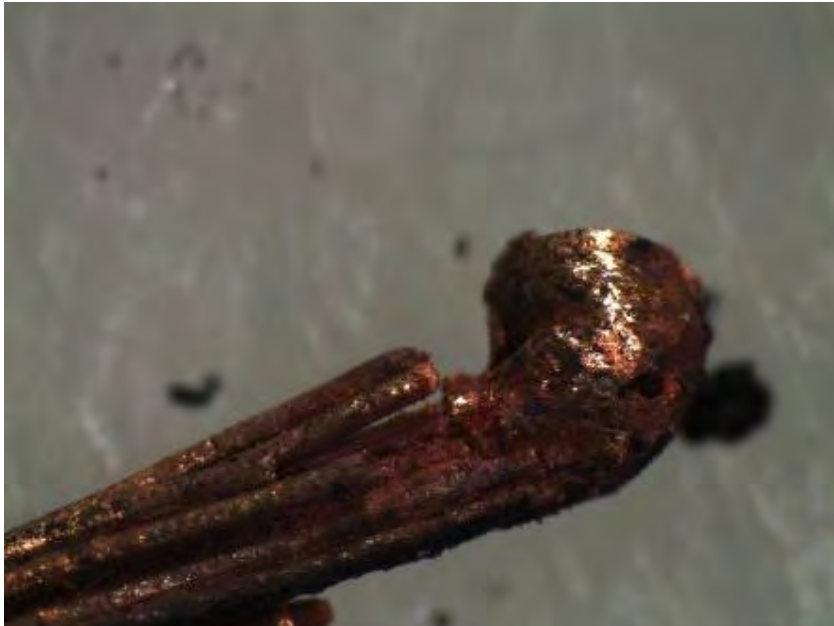
Bild 13. Smältskada på en av ledarna.
