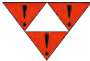
Etikett nr 15: Förbud mot skjutsning och att släppas från vall. Ska framföras av tillkopplat draglok. Får inte utsättas för stötar och ska skyddas mot stötar från andra järnvägsvagnar.
