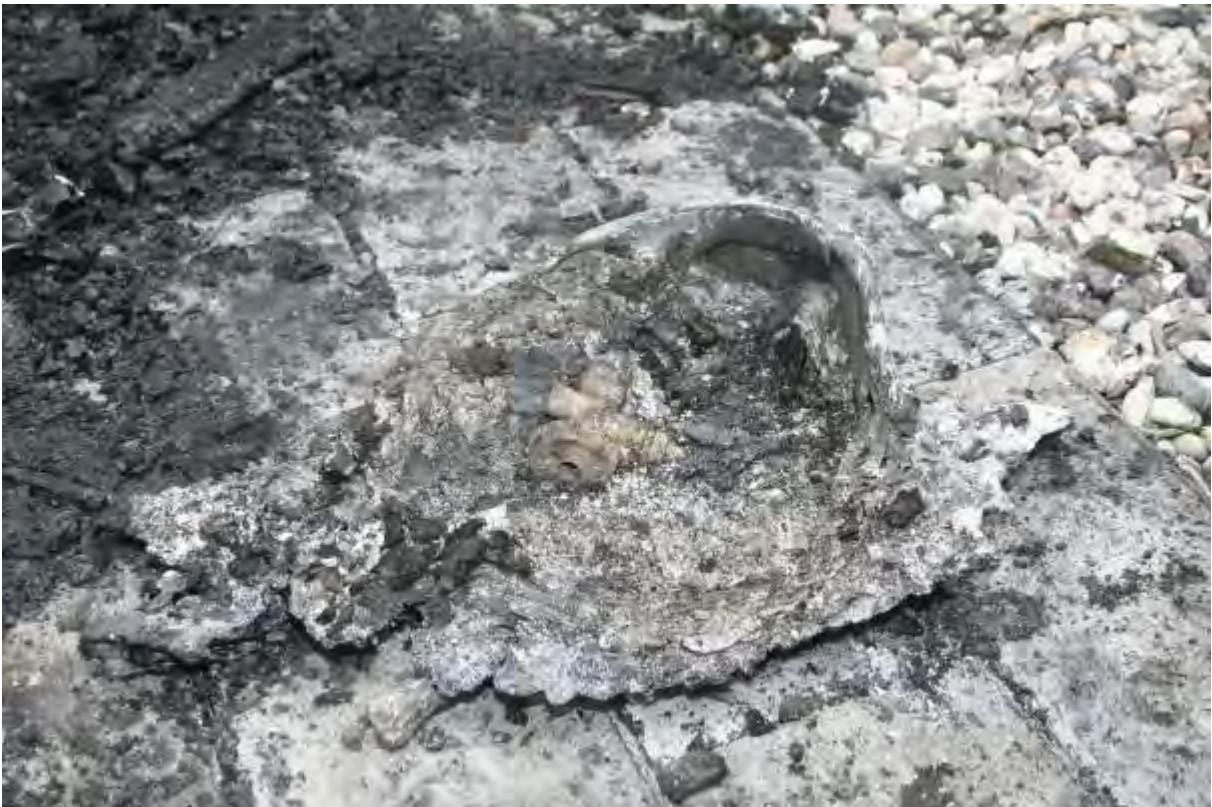
Bild 4. Den smälta gasoltuben
