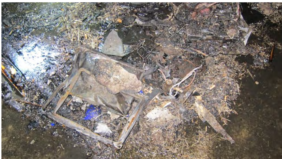
Resterna av en TV som fanns i förrådet.
