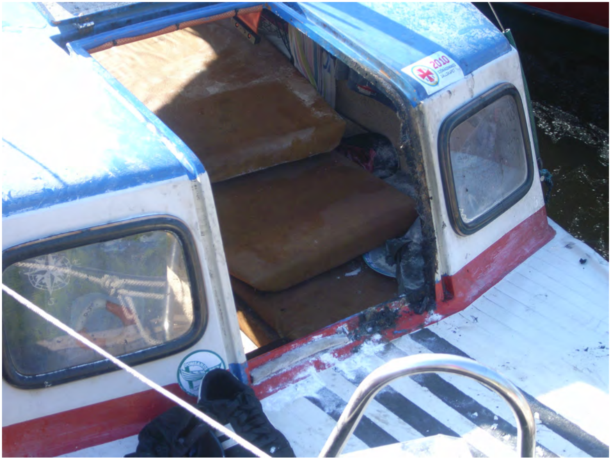
Bild 4. Det brandskadade området i båten.
