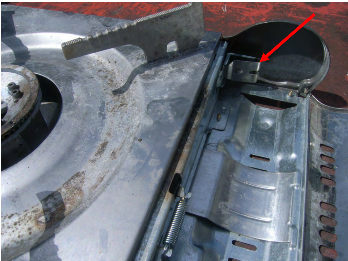
Bild 3. Klacken som trycker på gasolbehållaren.
