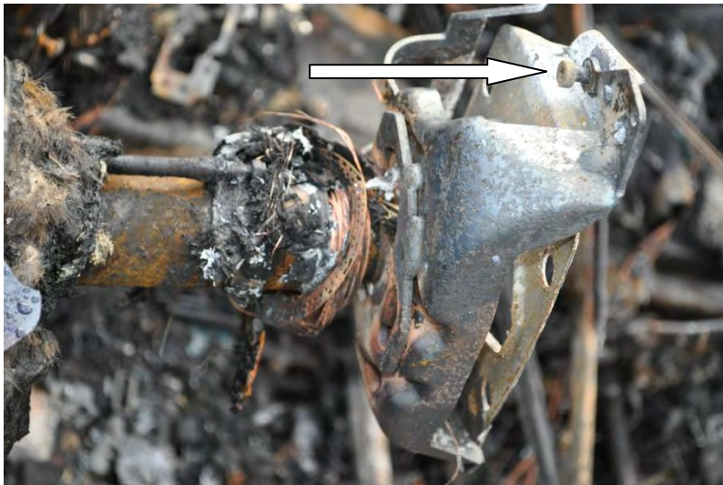
Infästning från sida (OBS skruvensom håller airbagen delvis utskruvad på båda sidor.)
