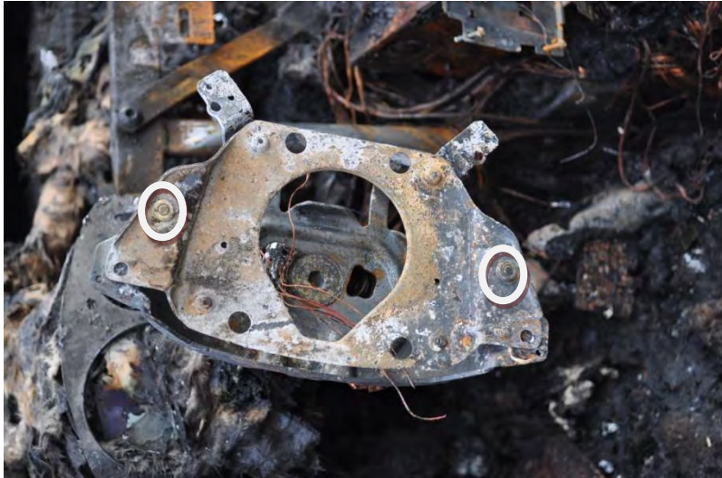
Rattens infästning för airbag. Skruvar som håller airbag markerade.
