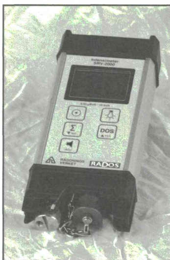
Det nya mätinstrumentet Intensimeter SRV 2000. Vid mätning på fast mätställe bör instrumentet stå fritt placerat moterat på ett stativ på ca 1,0 m höjd.
