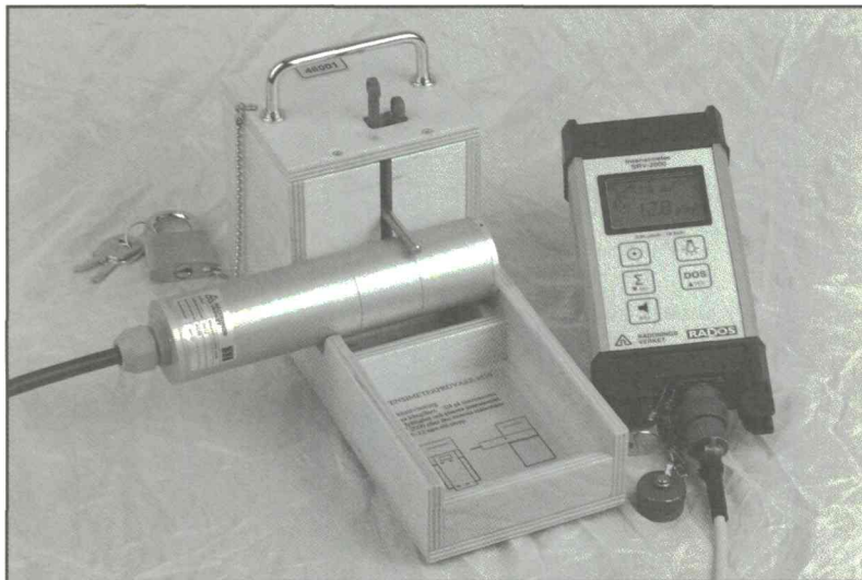
Intensimeterprovare. För kontroll av sond och Intensimeter SRV 2000.
