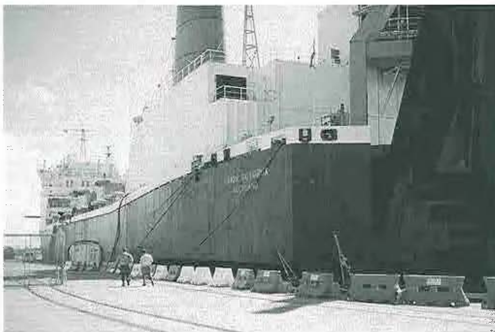
Foto 1. En fartygsmonterad gasturbin levererade ca 8% av effektbehovet under den mest kritiska tiden. Oljeförbrukningen uppgick till 110 ton/dygn. FOTO: MATS KERO
