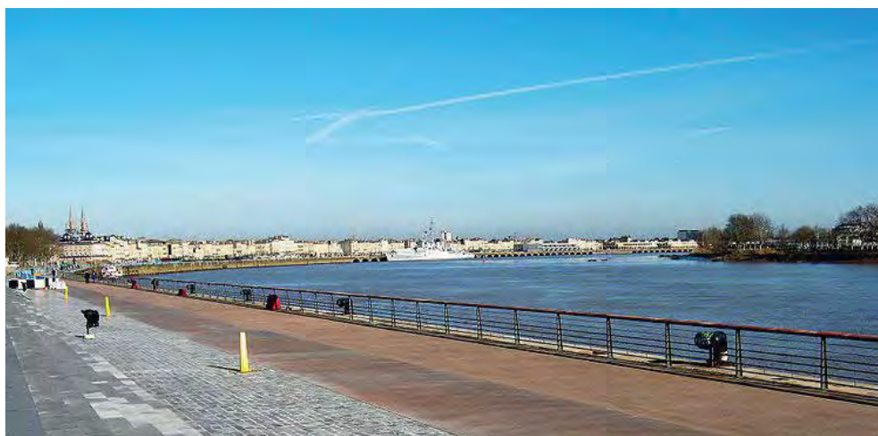
Exempel på räcke vid en kaj i Bordeaux, Frankrike. I områden med många barn, t.ex. vattennära bostadsområden, bör nedre 0,9 m uppfylla rekommendationerna för barnsäkrare räcke med bland annat vertikala spjälor. Foto: Boverket.
