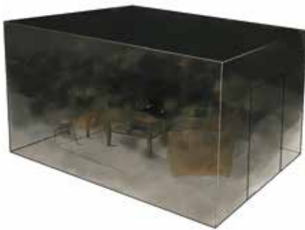
Figur 86. Brandgaserna självantänder vid kontakt med luften.
