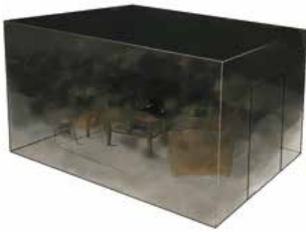
Figur 85. Brandförloppet återupptas. Dörren öppnas och brandgaserna strömmar ut. Efter ett tag kan man observera flammor uppe under taket och snart syns flammor i hela utrymmet.
