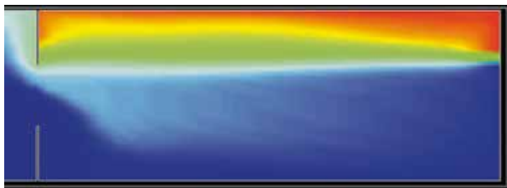
Figur 101. Det finns fortfarande brännbara gaser högst uppe i rummet.
