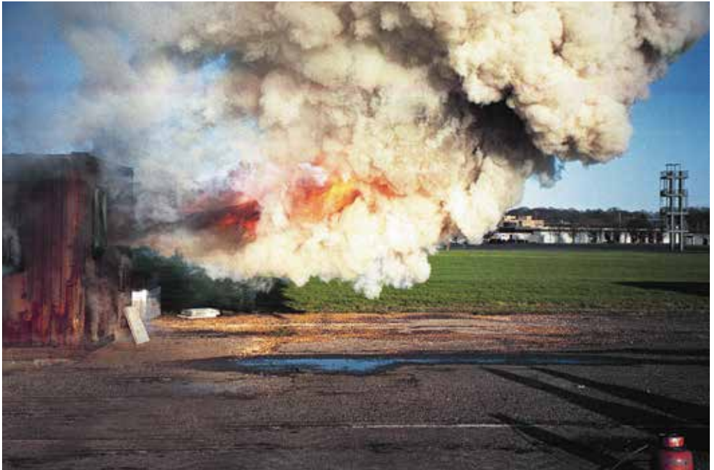
Figur 68. Vita brandgaser är definitivt inte ofarliga. I det här fallet är bränslet någon typ av träskivor placerade i taknivå. Brandgasernas färg beror till stor del på om det är en glöd- eller flambrand.
