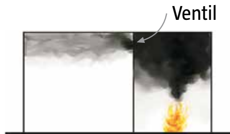
Figur 36. Brandgaser har läckt in i angränsande utrymme. Detta är ett brandscenario där för- blandade flammor kan uppstå.
