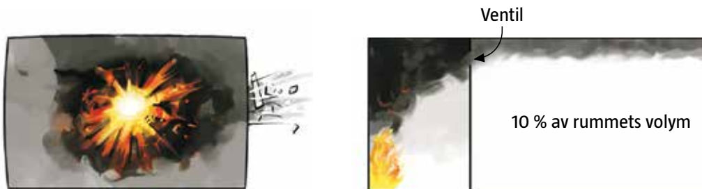
Figur 54 (till vänster). Tryckökning vid antändning.
