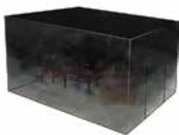
Figur 90. Bilden visar en ventilationskontrollerad brand som gått tillbaka till en glödbrand. Det bildas oförbrända brandgaser.
