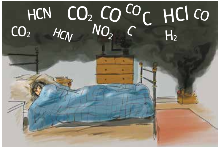
Figur 81 (ovan). Branden är på väg att självslockna i ett slutet utrymme. Brandgaserna sänker sig ner över brandhärden. Fri sikt finns endast vid golvet.
