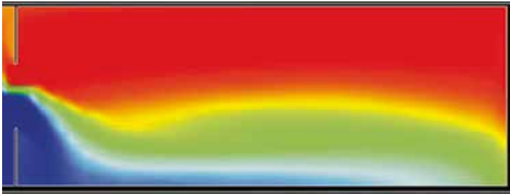
Figur 95. Luftströmmen har precis nått bakväggen. Det blandade området är stort.
