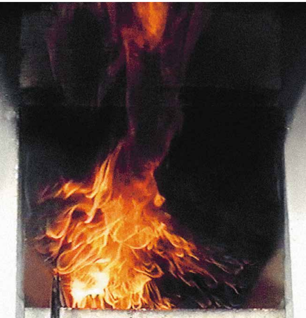
Figur 33. Flammor på undersidan av brandgaslagret.
