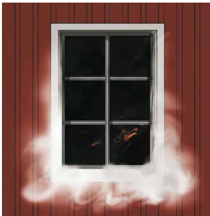
Figur 50. Termisk expansion i ett bostadsrum.
