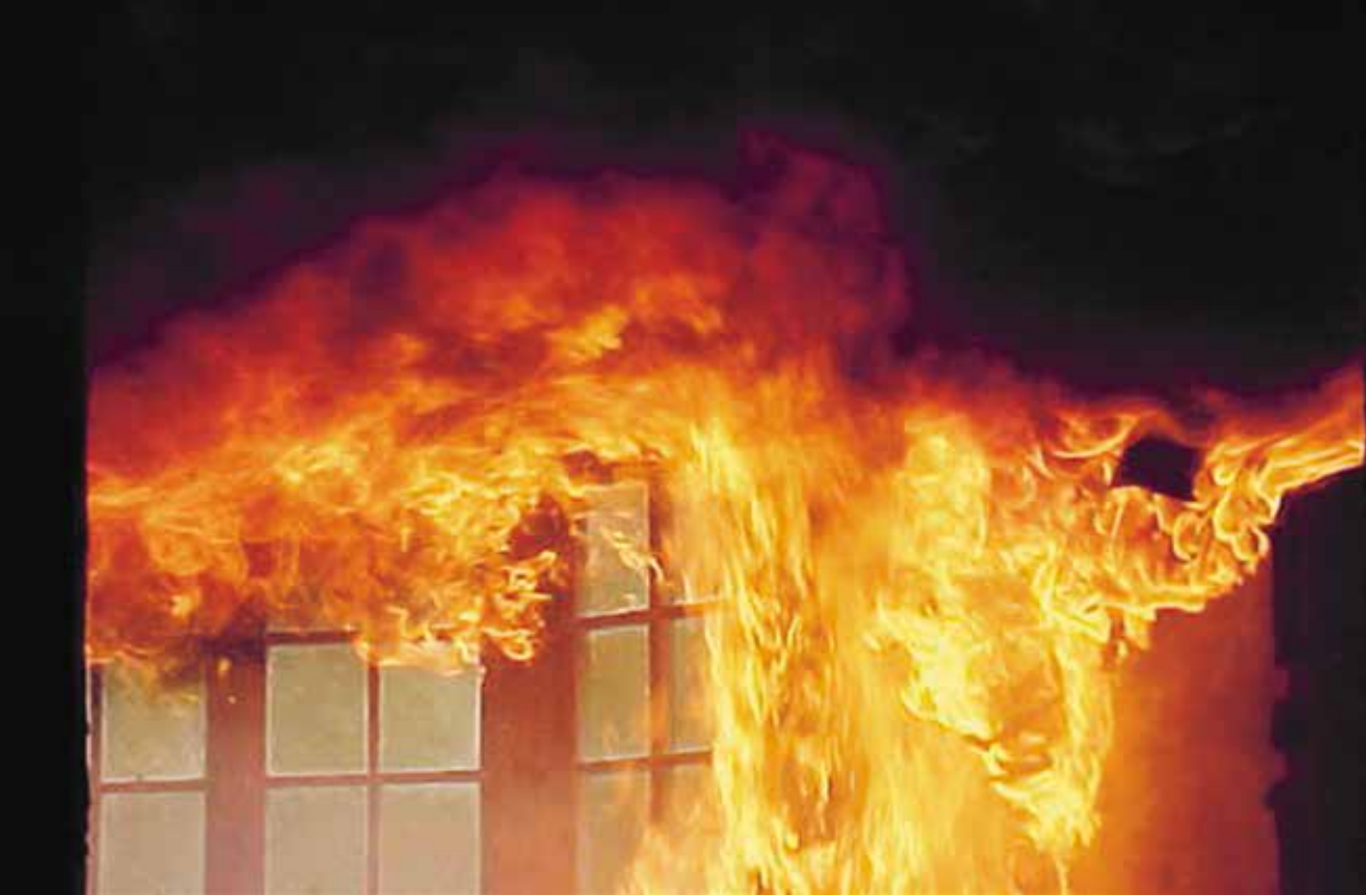
Figur 29. Branden börjar närma sig övertändning, strålning till alla andra delar av brandrummet ökar.
