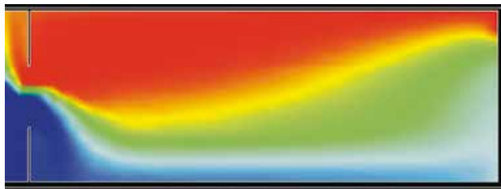
Figur 97. En större del är förblandad när luftströmmen vänt, nästan halva rummets volym.
