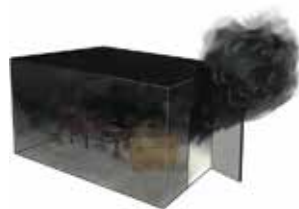
Figur 91. Luft strömmar in och brandgaser strömmar ut.
