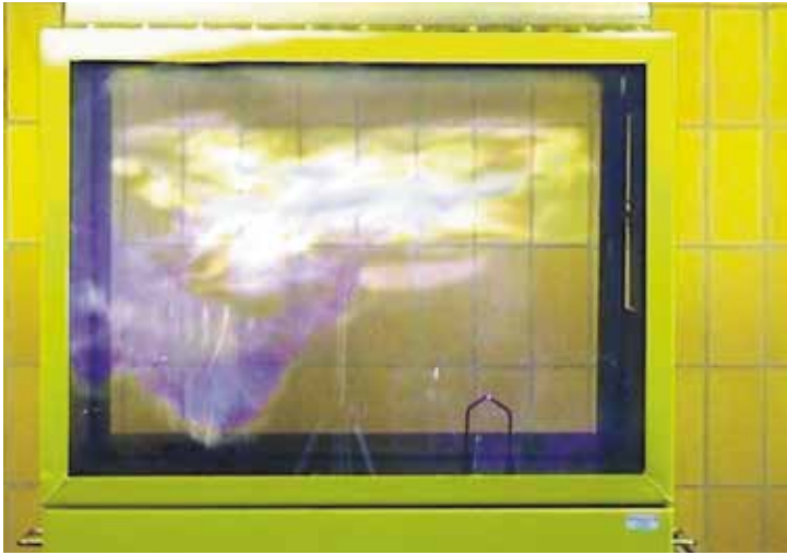
Figur 35. Förblandad flam- utbredning i "akvariet". Akvariet används för att demonstrera brännbar- hetsområden för olika gaser. Vanligast är att man använder gasol och luft.
