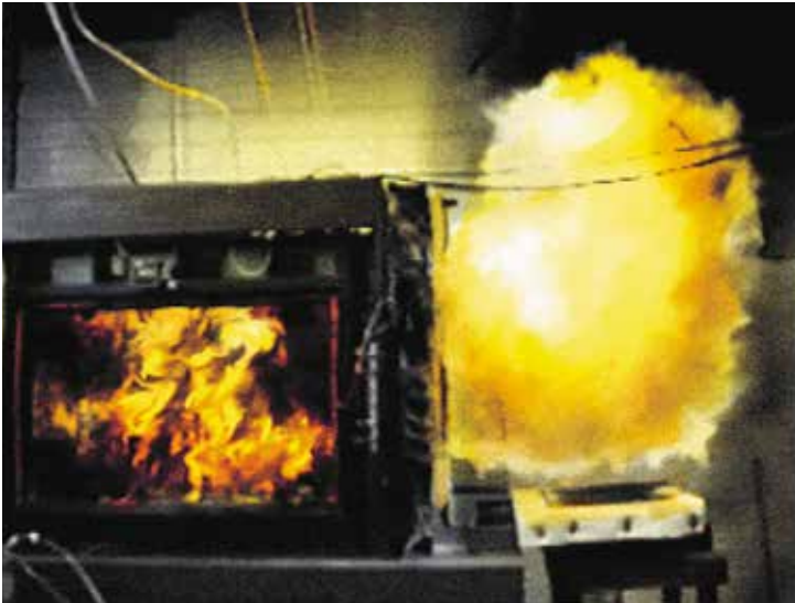
Figur 99 och 100. Eldklot som skapas pga. expansion av de varma brandgaserna.
