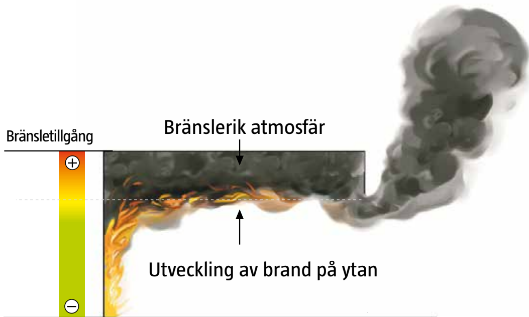
Figur 67. Utveckling av brand på undersidan av brandgaslagret.
