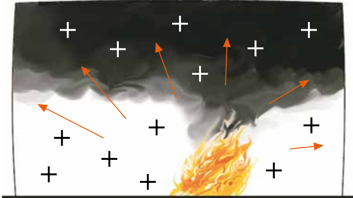
Figur 44. Luft/brandgaser värms upp, expanderar och tar större plats, vilket medför att trycket ökar.
