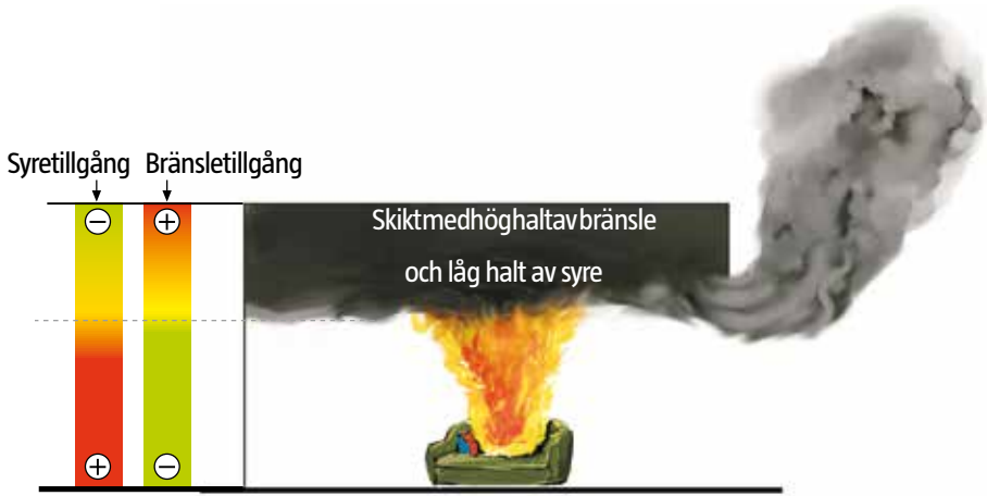
Figur 34. En hög koncentration av bränsle högt upp, leder så småningom till att flammorna kommer på undersidan av brandgaslagret.
