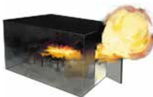
Figur 92. Antändning av den förblandade regionen, motsvarande det mörka området.
