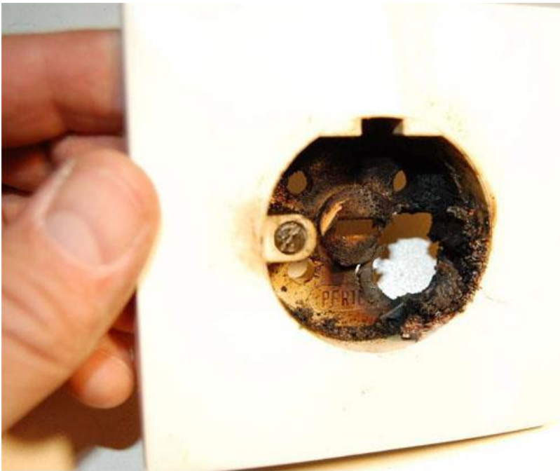
Bild 5. Bilden visar locket till eluttaget. Det stift som delvis smält bort har funnits i det hål som bildats i locket.
