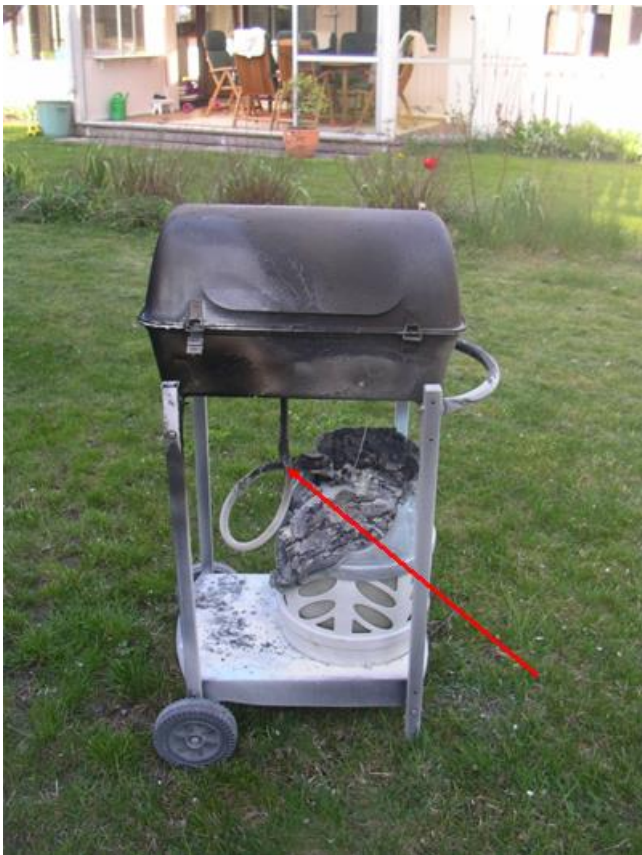
Den brandskadade grillen med gasolflaskan, den brandskadade slangen är mitt för sprickan i reduceringsventilen.
