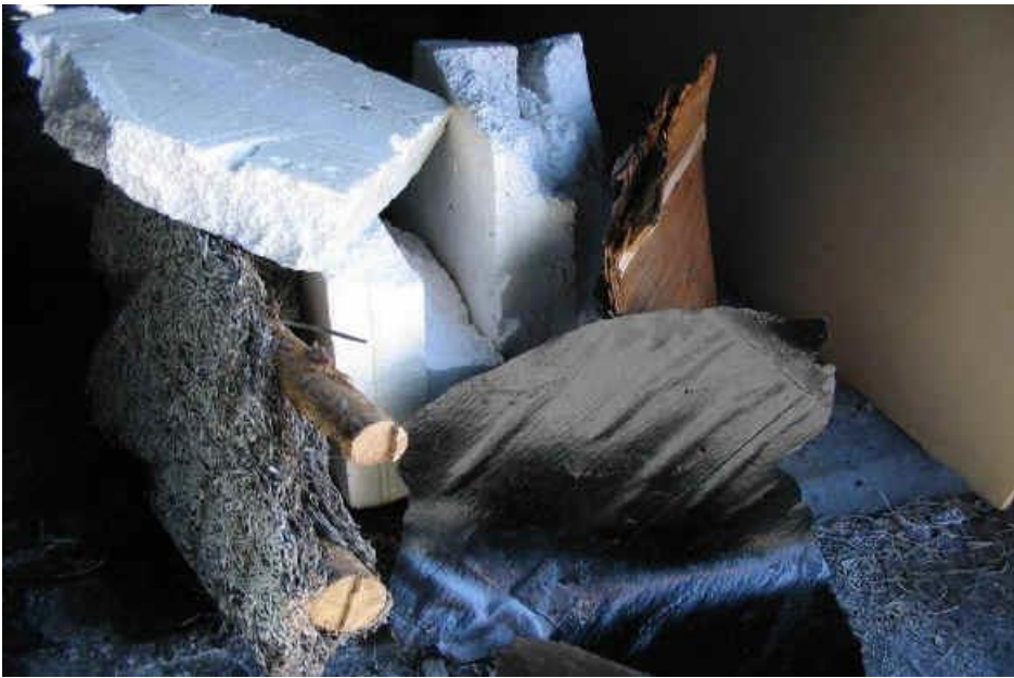
Materiel som proveldades. Plywood, tjärpapp, frigolit och cementbunden träfiber
