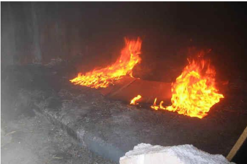
Efter ca 2 min är all frigolit borta. Den har starkt bidragit till den brandspridning som skedde i taket.
