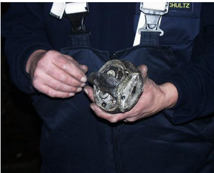
Lägenhetens brandvarnare, fungerade även efter branden.
