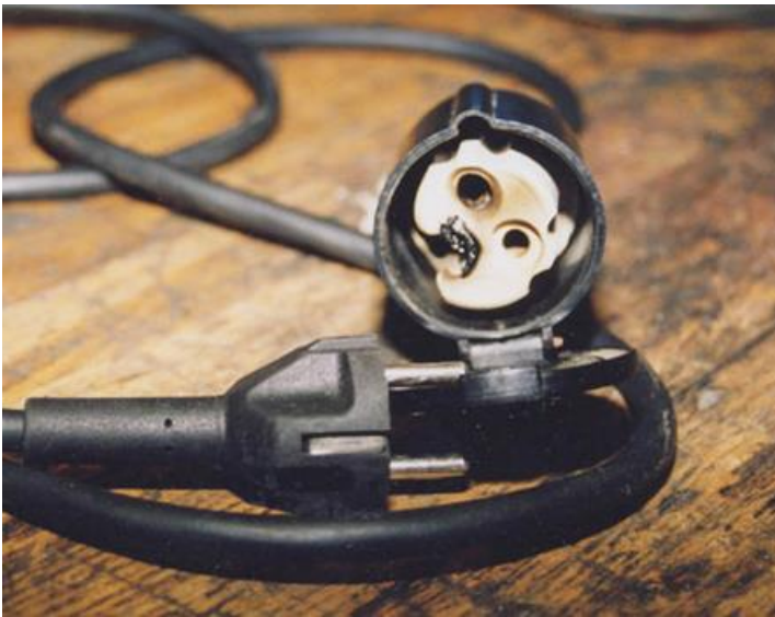
Förlängningsladdens honkontakt före demontering.
