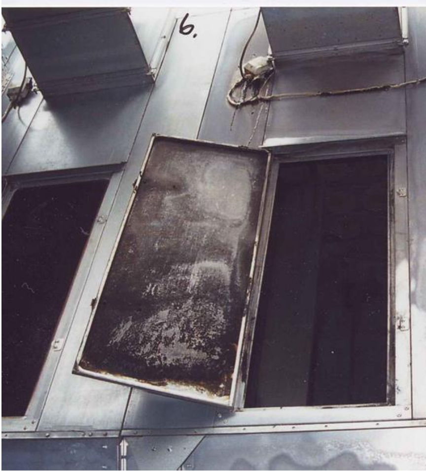
"Strumporna" inne i den stora behållaren tog eld och brann upp. Det blev också en glödbrand i spånet på behållarens botten.
