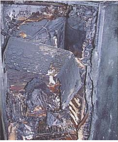
Brandskadad inredning i kylskåp.
